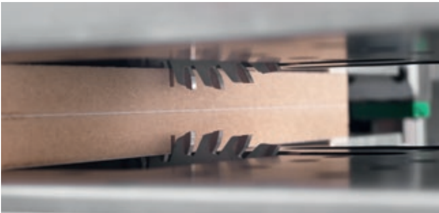
Gruppi lama per canali in direzione X.
